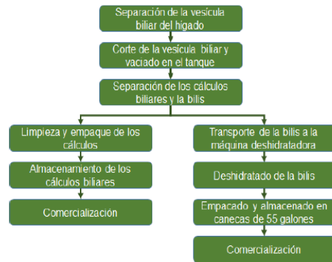
Figura 3. Flujo de proceso de la bilis y los cálculos biliares en la Planta de subproductos
