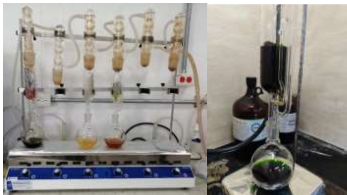
Figura 2. Proceso de extracción de lípidos de la biomasa de spirulina.
