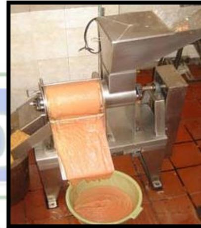
En esta etapa se separa y retira las semillas de la pulpa para obtener una pasta acuosa. Se realiza con despulpadoras mecánicas donde se presiona la fruta contra un tamiz o malla perforada de acero inoxidable.
