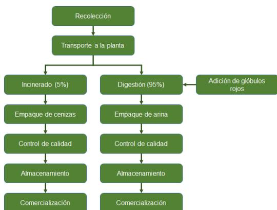
Figura 7. Proceso de decomisos en la planta de subproductos
