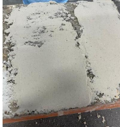
Fig2. Mezcla almidón-cemento
