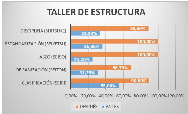
Fig. 16. Gráfico de barras con los resultados de inspección 5S antes y después de la implementación de la metodología en el taller de estructura. Fuente: Elaboración propia
