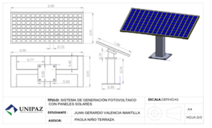
Fig. 8. Plano arquitectónico del panel solar
