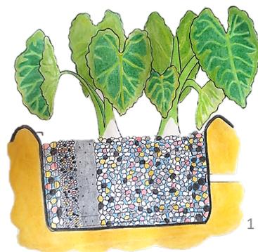
Los humedales artificiales generan una alternativa como tecnología apropiada para la descontaminación de aguas generadas por vertimientos. Mediante procesos físicos, químicos y biológicos las plantas acuáticas y algunos microorganismos metabolizan los contaminantes mediante procesos de **fitorremediación, rizorremediación y biorremediación.**
