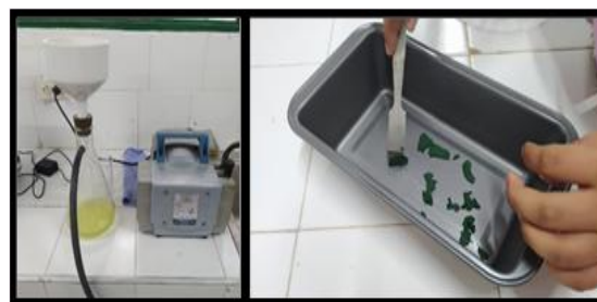
Figura 3. Filtrado y secado de la biomasa a partir de A. platensis
